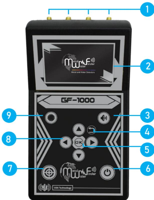
1 Ranuras para conectar antenas transmisoras y receptoras
